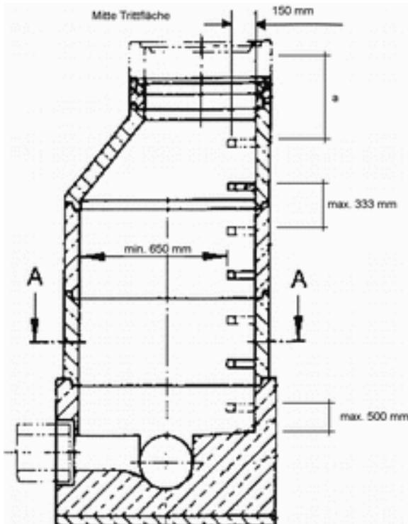
Das höchstzulässige Maß  $a$  für den Abstand Schachtoberkante bis zu einem ersten Steigbügel darf in Ausnahmefällen beim Höhenausgleich bis zu 240 mm das Regelmaß von 500 mm um max. 150 mm übersteigen. Ein Höhenausgleich über 240 mm durch Ausgleichsringe ist nicht zulässig.
