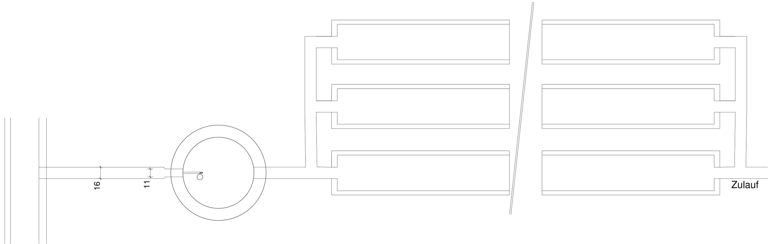
Systemzeichnung: Rückhaltung mittels Betonrohre
